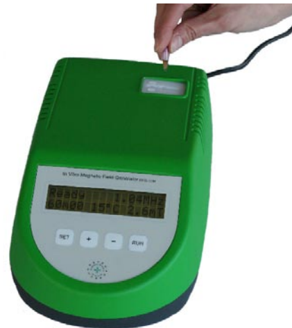
In Vitro Magnetic Field Generator MFG-1000 (magnetfältsgenerator för medicinsk forskning). Provbehållaren med magnetiska nanopartiklar och vävnader, celler (t ex cancerceller) eller andra biologiska molekyler appliceras i instrumentet enligt bilden och utsätts för ett starkt växlande magnetfält som gör partiklarna heta, vilket påverkar vävnaden/cellen.
