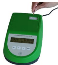
In Vitro Magnetic Field Generator MFG-1000 (magnetfältsgenerator för medicinsk forskning som kan användas tillsammans med Implementas peptidnanopartiklar).
